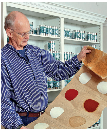
Maluj na chłonnych powierzchniach! Jeden prosty test, aby sprawdzić penetrację i zdolności ochronne farby / oleju.
